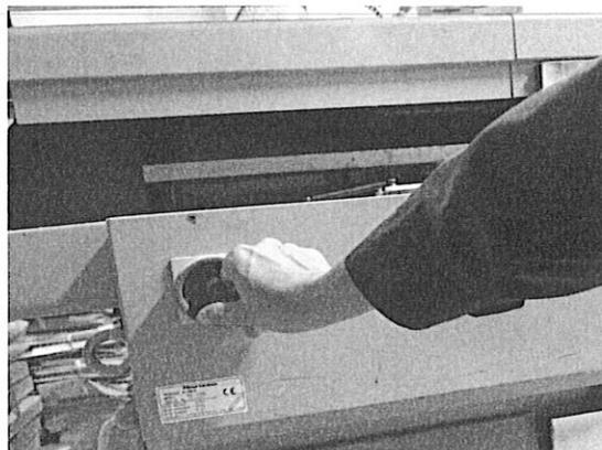
3.2 รอประมาณ 30 นาที ให้เครื่องทำความร้อน รอดอุณหภูมิได้ที่ กาวที่แข็ง จะอ่อนตัว จนเหลว พร้อมใช้งาน กาวในบ่อกาวจะเหลวอ่อนตัวจนทำให้ แกนเหล็กในบ่อกาวหมุนแสดงว่าพร้อมใช้งานแล้ว
